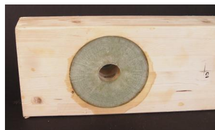
Abbildung 4: verstärkter Lochbereich mit eingeklebtem Patch
