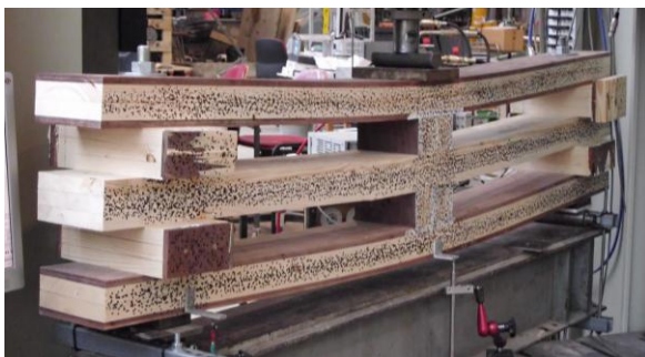
Abbildung 6: Biegeversuch eines nachgiebigen Trägers
