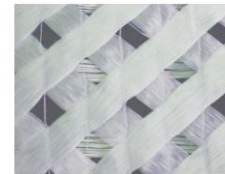
nähgewirktes Multiaxial-Gelege 60°/90° und seine technische Umsetzung
