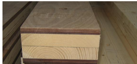
Abbildung 2: Anschlussverstärkungen mit KHP
