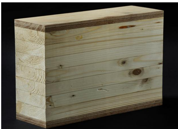
Abbildung 1: Abschnitt eines BSH-Trägers mit KHP-Decklamellen
