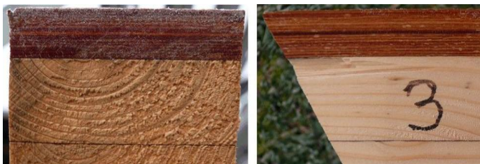
Abb. 6: KHP-BSH-Hybridträgerschnitte in der Freibewitterung
