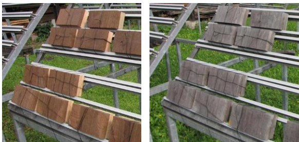
Abb. 7: TMT-Lärche-Hybridbohlenschnitte in der Freibewitterung
