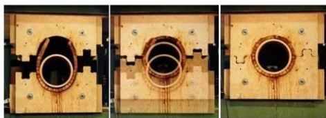
Abb.1: Pilotanlagen zum Herstellen von Formholzröhren
