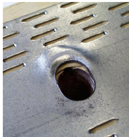
Abb. 2: Nagelplattenverstärkung (Nageldübel) von stiftförmigen Verbindungsmitteln nach [2]
