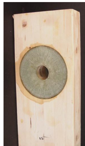
Abb. 1: Stabdübelverbindung mit Verstärkungen aus Patches (FKV), (a) System und (b) eingeklebtes Patch im Bauteil
